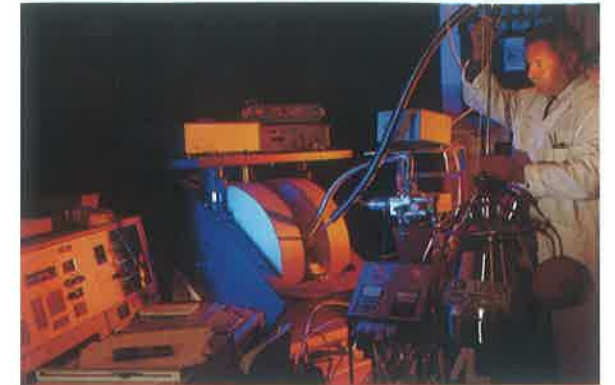
Montage d'une sonde pour l'étude des ions en phase gazeuse
